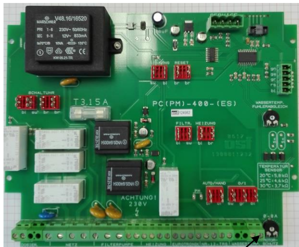
Установка защиты мотора
